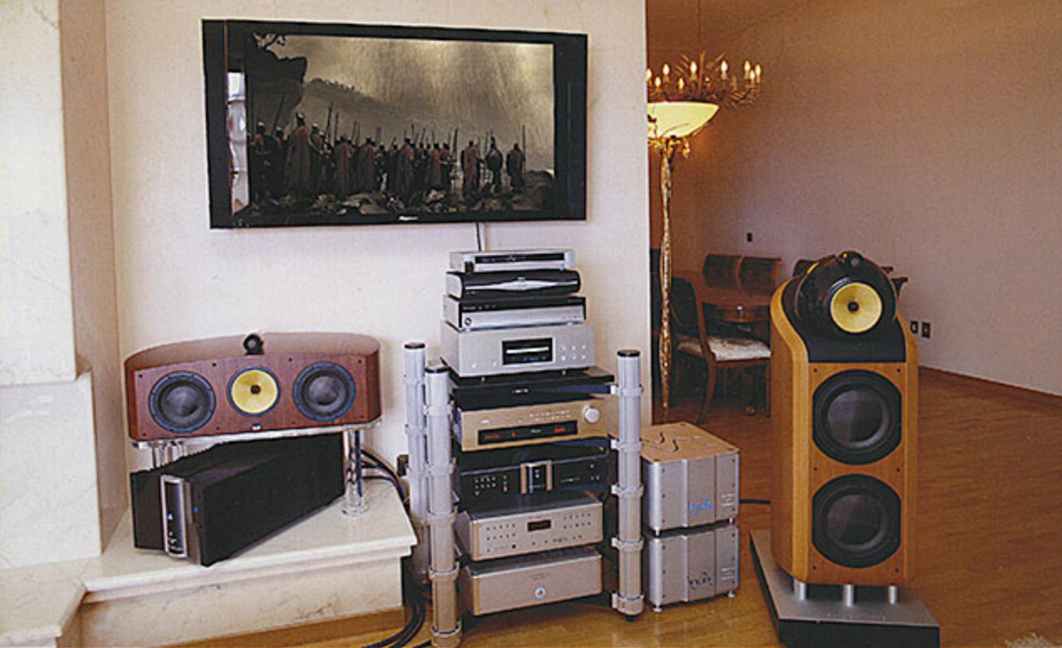
Οι πηγές και οι προενισχυτές έχουν τοποθετηθεί σε ρακ ειδικής σχεδίασης της Solid Tech, μέσω του οποίου εξασφαλίζονται η μηχανική τους απομόνωση από τους κραδασμούς που δημιουργούν τα ηχεία, αλλά και η σωστή μηχανική τους γείωση. Το κεντρικό ηχείο εδράζεται σε ειδική ιδιοκατασκευή από plexiglas, η οποία συμβάλλει στην άρτια μηχανική του στήριξη, ενώ αισθητικά επιτυγχάνεται το εντυπωσιακό αποτέλεσμα της αιώρησης, καθώς η κατασκευή είναι εντελώς διάφανη.
